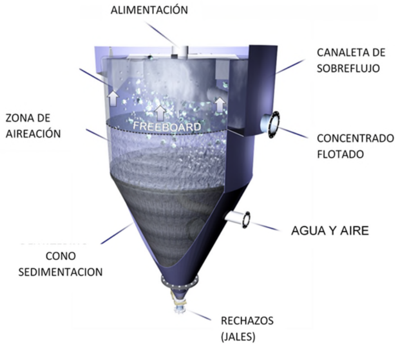
Figura 2: Corte transversal del equipo HydroFloat™ Eriez
